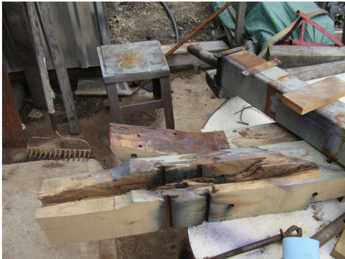
Part of the carriage and axle tree of a gun severely rotten. Section de l'affût et de l'essieu rouillé et pourri.
