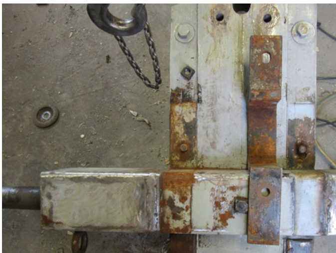
Part of the carriage and axle tree of a gun severely rotten. Section de l'affût et de l'essieu rouillé et pourri.
